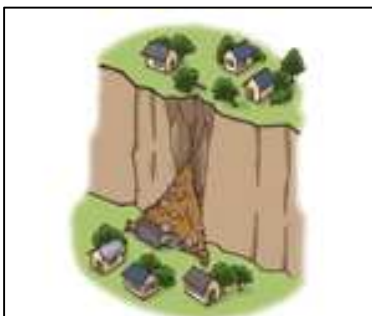
【急傾斜地の崩壊】
