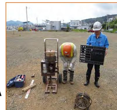
\*  $30\text{kN/m}^2$ 以上とは、一般的な木造2階建住宅の基礎が、地盤補強なしに通常の布基礎で建築できることを参考に設定された目標強度です。実際には、ハウスメーカーなどの設計により建物の基礎形状が決まってくるので、地盤補強なしで必ず建てられるということを保証するものではありません。
