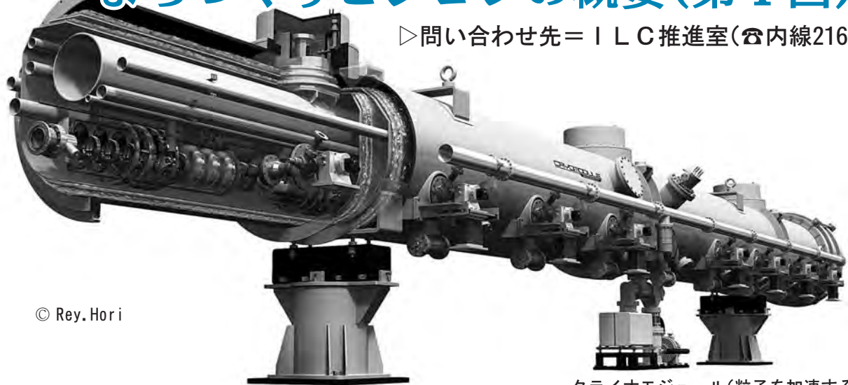
クライオモジュール(粒子を加速する装置)
